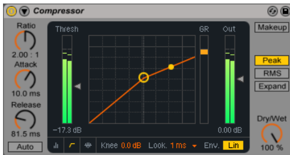
Courbe de transfert du compresseur.
